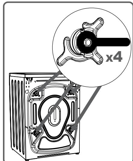
Pomocí odpovídajícího klíče uvolněte šrouby otáčením proti směru hodinových ručiček.
