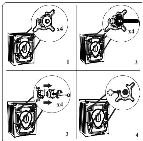
1. Než pračku uvedete do provozu, odstraňte z její zadní části 4 přepavní šrouby a pryžové podložky. Pokud šrouby nebudou odstraněny, mohou způsobit silné vibrace, hluk a nesprávnou funkci pračky a vést ke ztrátě záruk.
