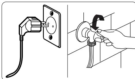
Před přistoupením k údržbě a čištění vypněte spotřebič a vytáhněte zástrčku napájecího kabelu ze zásuvky. Před zahájením údržby a čištění pračky zavřete přívod vody.
