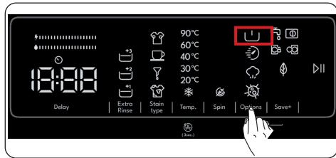
Цю допоміжну функцію можна використовувати для попереднього прання білизни зі значими забрудненнями, що передує основному циклу прання. Перед використанням цієї функції в дозатор попереднього прання висувного відсіку для мийного засобу потрібно додати очисний засіб. Для активування допоміжної функції попереднього прання натискайте кнопку додаткових варіантів прання до появи позначки . Якщо світлодіодний індикатор електронного дисплея постійно світиться, це свідчить про вибір допоміжної функції.
