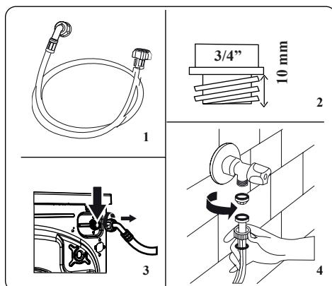
1. Машина може мати або одне з'єднання для підведення води (холодної), або два з'єднання для підведення води (гарячої та холодної), залежно від технічних характеристик машини. Шланг із білою заглушкою треба під'єднати до патрубка подавання холодної води, а шланг із червоною кришкою — до патрубка подавання гарячої води (якщо є).
