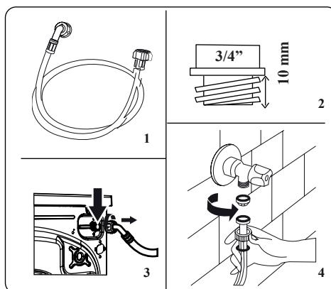
1. V závislosti na specifikacích pračky může být vaše pračka připojena k přívodu studené vody nebo k přívodu studené a teplé vody. Hadice s bílým uzávěrem by měla být připojena k přívodu studené vody a hadice s červeným uzávěrem k přívodu horké vody (pokud je k dispozici).
