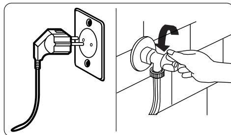
Przed przystąpieniem do konserwacji i czyszczenia pralki wyłączyć zasilanie i wyjąć wtyczkę z gniazdka. Przed rozpoczęciem konserwacji i czyszczenia zakręcić dopływ wody.
