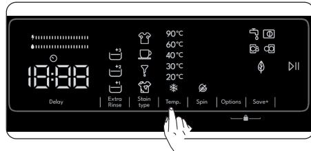
Pomocí tlačítka pro nastavení teploty vody můžete nastavit teplotu vody pro praní vašeho prádla.
