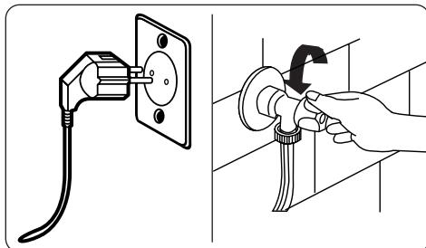
Перед початком технічного обслуговування й чищення машини вимкніть живлення та вийміть вилку з розетки. Перед початком технічного обслуговування й чищення машини перекройте кран подавання води.
