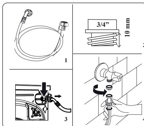
1. Pralka może posiadać pojedyncze podłączenie dopływu wody (zimnej) lub podwójne (gorącej i zimnej) w zależności od specyfikacji urządzenia. Wąż z białą osłoną należy podłączyć do dopływu zimnej wody, a z czerwoną do dopływu gorącej wody (jeżeli jest dostępny).
