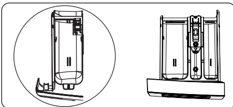
Tento oddíl je určen pro tekuté nebo práškové prací prostředky nebo odstraňovač vodního kamene. Měrka hladiny tekutého pracího prostředku se nachází uvnitř spotřebiče. (\*)
