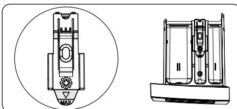
Przegroda ta jest przeznaczona na płyny zmiękczające, płyny do płukania lub krochmal. Należy przestrzegać instrukcji podanych na opakowaniu.
