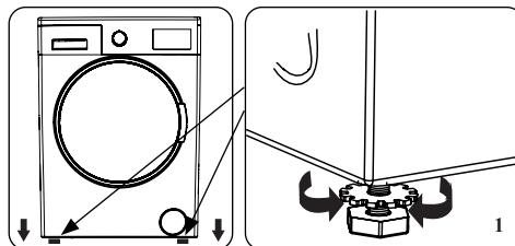
1. Не встановлюйте машину на поверхні (наприклад, килимові покриття), які перешкоджають вентилюванню біля основи.
