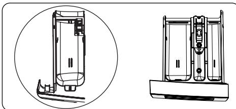
Przegroda ta jest przeznaczona na detergenty płynne lub w proszku bądź odkamieniacz. Płytki poziomu płynnego detergentu jest dostarczona w pralce. (\*)
