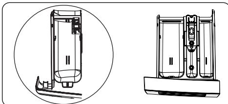
Tento oddíl je určen pro tekuté nebo práškové prací prostředky nebo odstraňovač vodního kamene. Měrka hladiny tekutého pracího prostředku se nachází uvnitř spotřebiče. (\*)
