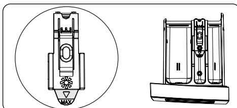
Przegroda ta jest przeznaczona na płyny zmiękczające, płyny do płukania lub krochmal. Należy przestrzegać instrukcji podanych na opakowaniu.
