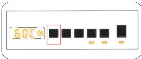
Po zvolení programu se automaticky nastaví maximální teplota pro tento program. Chcete-li teplotu změnit, stiskněte tlačítko pro nastavení teploty vody, dokud se na digitálním displeji nezobrazí požadovaná teplota. Teplotu vody můžete postupně snižovat, a to mezi maximální teplotou vody vybraného programu a praním za studena (- - C) jednoduše stisknutím tlačítka pro nastavení teploty.
