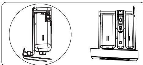
Przegroda ta jest przeznaczona na detergenty płynne lub w proszku bądź odkamieniacz. Płytki poziomu płynnego detergentu jest dostarczona w pralce. (\*)
