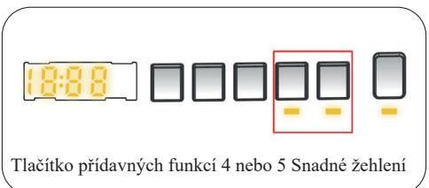
Tlačítko přídavných funkcí 4 nebo 5 Snadné žehlení
