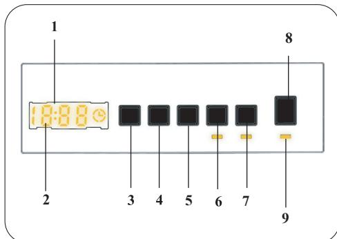
Na panelu wyświetlacza widoczny jest programator opóźnienia prania (jeżeli jest ustawiony), wybór temperatury, prędkość wirowania, wszystkie wybrane funkcje dodatkowe. Na panelu wyświetlacza widoczny jest „Koniec”, gdy wybrany program zostanie zakończony. Panel wyświetlacza wskazuje również, czy w pralce wystąpił błąd.
