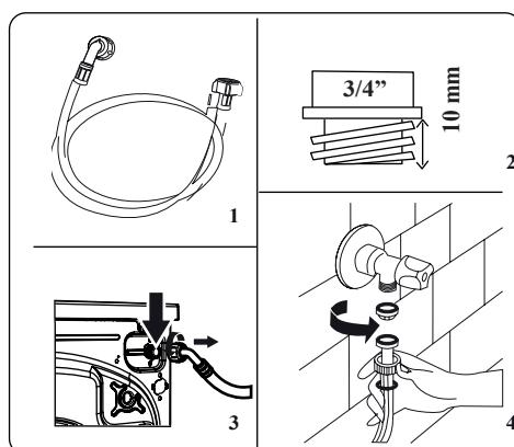
1. Pralka może posiadać pojedyncze połączenie dopływu wody (zimnej) lub podwójne (gorącej i zimnej) w zależności od specyfikacji urządzenia. Wąż z białą osłoną należy połączyć do dopływu zimnej wody, a z czerwoną do dopływu gorącej wody (jeżeli jest dostępny).
