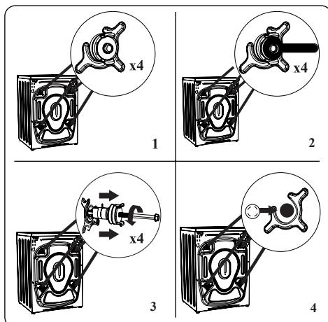
1. Než pračku uvedete do provozu, odstraňte z její zadní části 4 přepavní šrouby a pryžové podložky. Pokud šrouby nebudou odstraněny, mohou způsobit silné vibrace, hluk a nesprávnou funkci pračky a vést ke ztrátě záruky.
