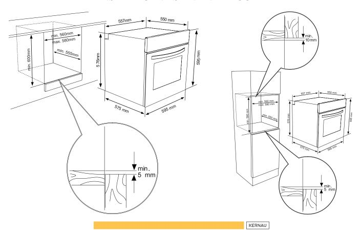
Troubu zasuňte do skříně. Otevřete dveře trouby a do otvorů v rámu trouby zasuňte 2 šrouby. Zatímco se rám produktu dotýká dřevěného povrchu skříně, šrouby utáhněte.
