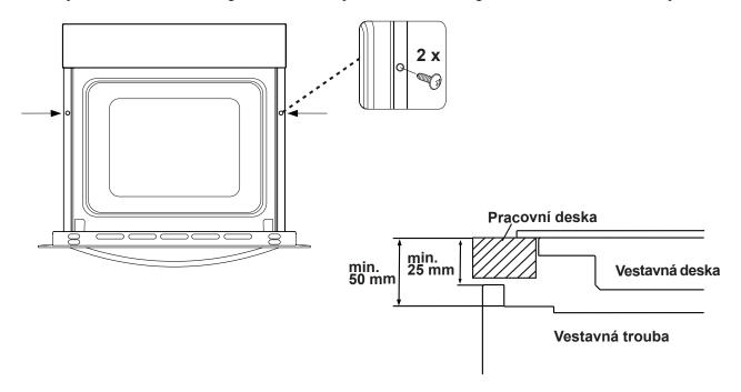
Je-li trouba nainstalovaná pod plotnou, vzdálenost mezi pracovní plochou a horním panelem trouby musí být minimálně 50 mm a vzdálenost mezi pracovní plochou a horní částí ovládacího panelu musí být minimálně 25 mm.
