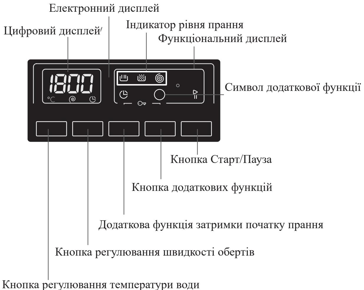
За допомогою світлодіодних функціональних індикаторів машини ви можете побачити, скільки часу повинно пройти, щоб запустити новий цикл, додаткові функції, які ви вибрали, і цикл програми, в якому працює машина (попереднє прання/прання , полоскання , віджим ).
